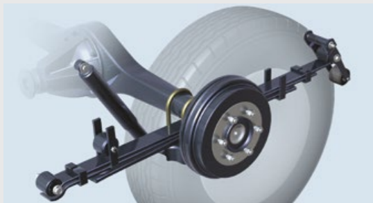
Задняя подвеска: зависимая рессорная с телескопическими амортизаторами
